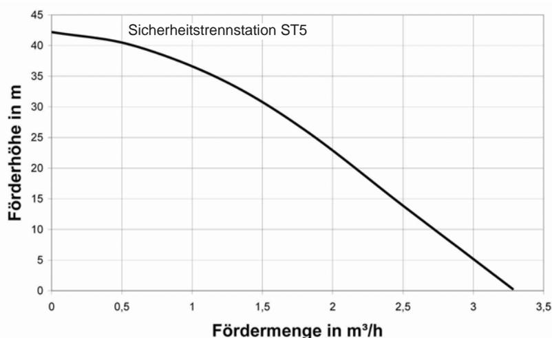
Diese Übersicht basiert auf einer kinematischen Viskosität von 1 mm<sup>2</sup>/s und einer Dichte von 1.000 kg/m<sup>3</sup>.
