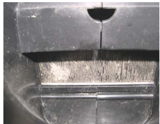
Rückseite eines stark verschmutzten Filtersiebes
