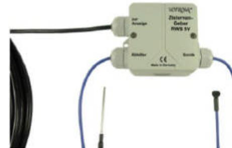
Der Zisternen-Geber RWS 2V (IP 68) ist für den Einsatz in Kellertanks (Kunststoff) konzipiert und wird hier von oben in den Tank gesetzt (BohrungØ63 mm) und mit der mit gelieferten Flanschdichtung am Tank verschraubt oder wird in einem Verschlussdeckel des Tanks montiert. Der Geber ist mit einer 3 m langen, 2adrigen Mantelleitung ausgestattet und gegen Feuchtigkeit voll vergossen. Besonderheit: Über eine eingebaute LED kann der ordnungsgemäße Betrieb
