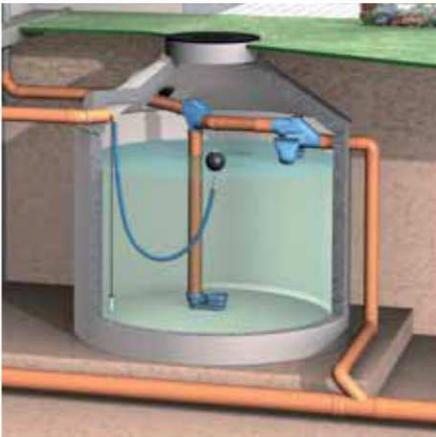
3P Filterpaket 350 für Dachflächen bis 350 m<sup>2</sup>
