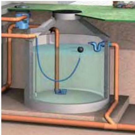
Höhendifferenzen zwischen Zulauf Regenwasser und Kanalanschluss
