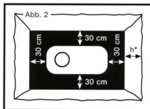
Bei Verwendung einer Domverlängerung und / oder eines Schiebedoms muß die Tiefe der Grube entsprechend verändert werden.
