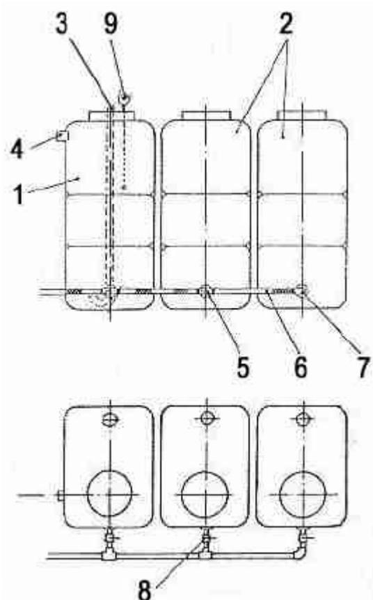
Dieses Aufstellschema zeigt die Kombination von einem Kellerbasistank und 2 Kellererweiterstanks mit entsprechendem Zubehör.
